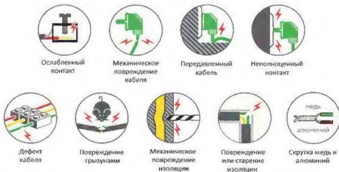
Рисунок 6. Возможные причины искрения в электропроводке
